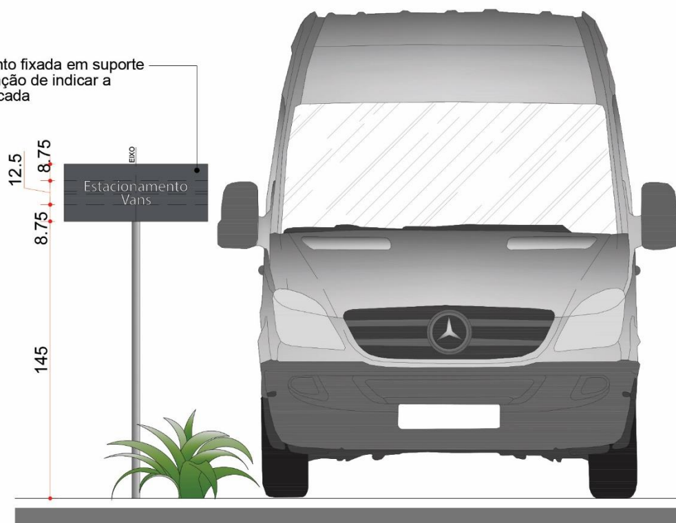
ELEVAÇÃO | FIXAÇÃO SUPORTE
